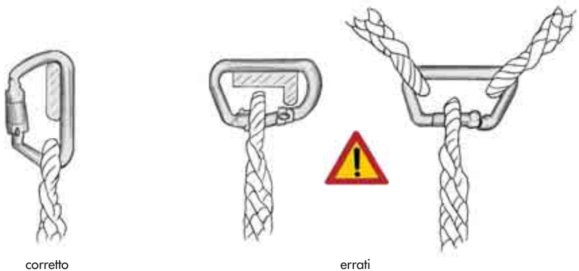
Fig. 16 - Carichi non in asse con la spina
